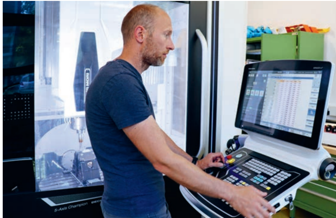
5-axis milling machine for precise and complex components. 5-Achs-Fräsmaschine für präzise und komplexe Bauteile.
