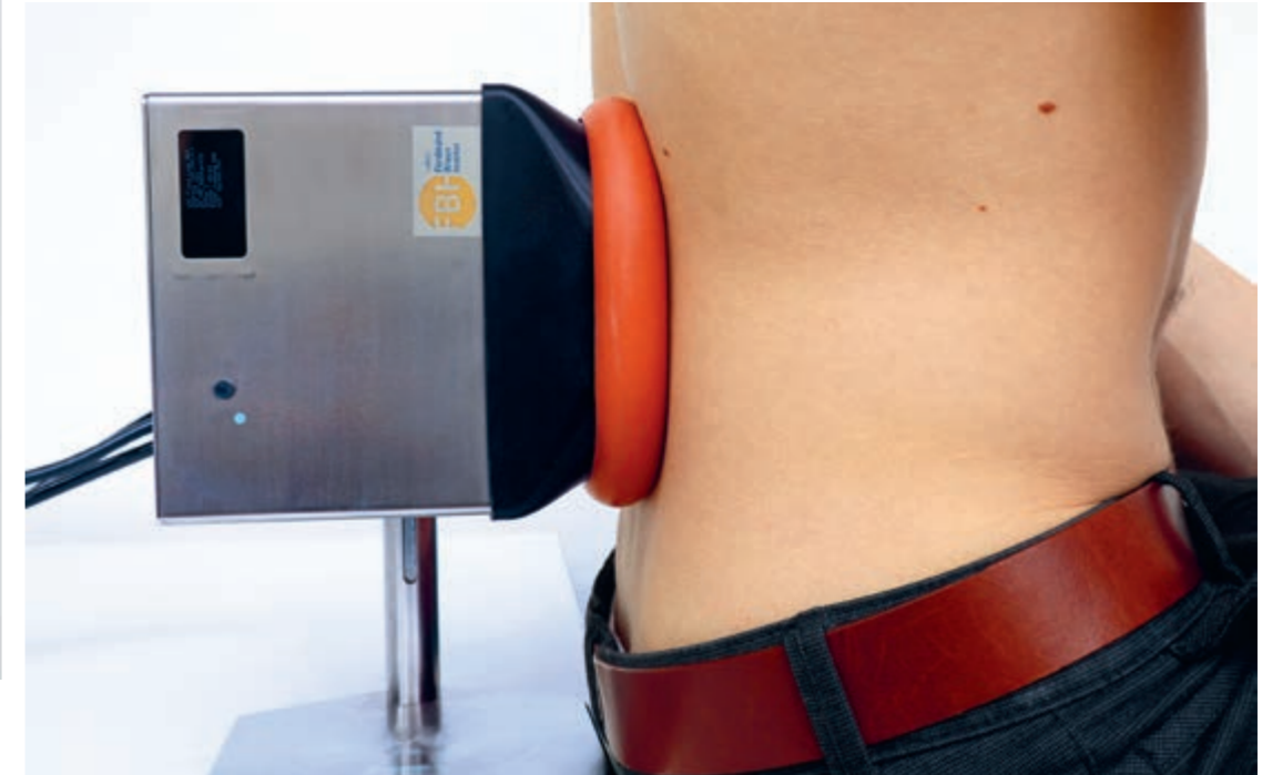
➤ UV LED irradiation system with which Charité is currently performing medical tests on human skin. UV-LED-Bestrahlungssystem, mit dem die Charité derzeit medizinische Tests an menschlicher Haut durchführt.
