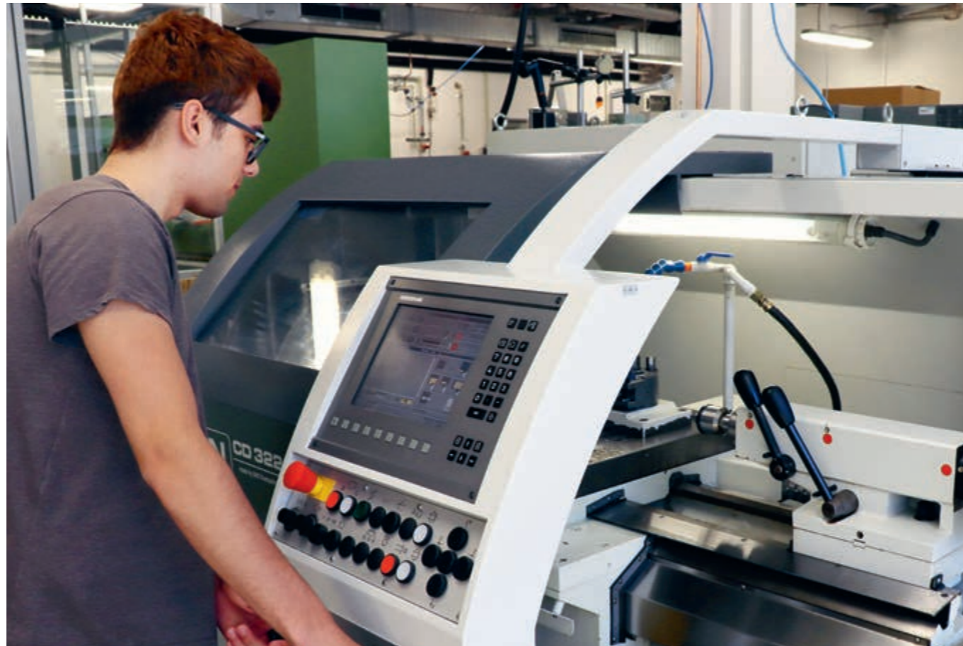
📍 CNC lathe for precision turned parts of various materials. CNC-Drehmaschine für Präzisionsdrehteile verschiedener Materialien.
