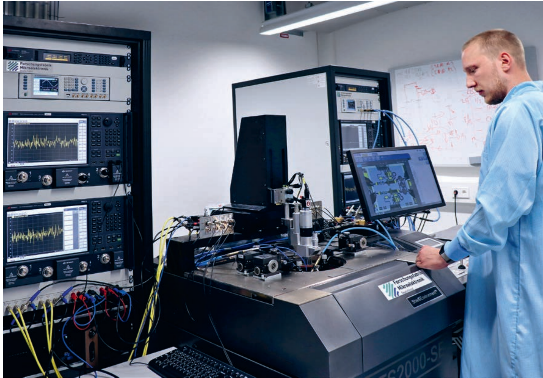
High-performance multi-channel mm-wave measurement facility at FBH, suitable, e.g., for the characterization of 5G-MIMO components. Leistungsfähiger Mehrkanal-Millimeterwellen-Messplatz am FBH, beispielsweise für die Charakterisierung von 5G-MIMO-Komponenten.
