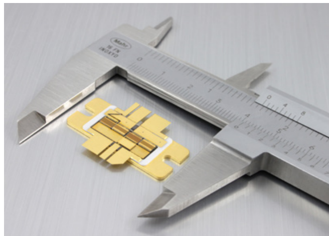
← GaN-based half bridge for inverters GaN-basierte Halbbrücke für Wechselrichter.
