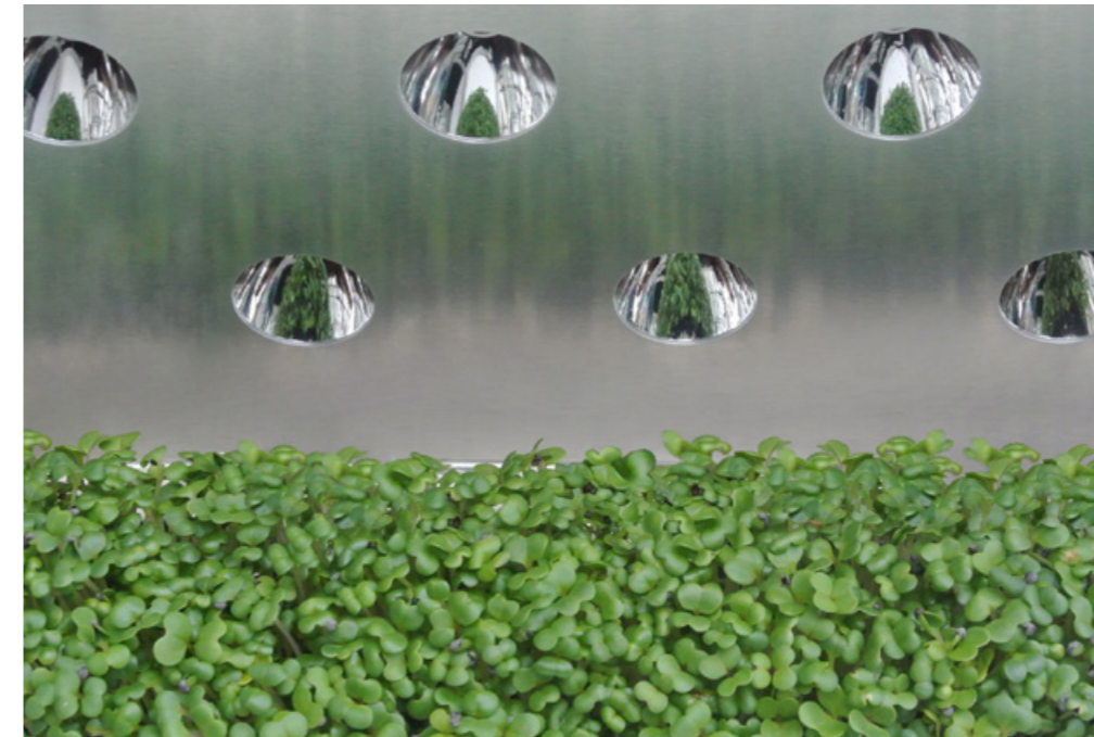
◀ First generation UV-LED module for plant illumination. UV-LED-Modul der ersten Generation für die Pflanzenbeleuchtung.
