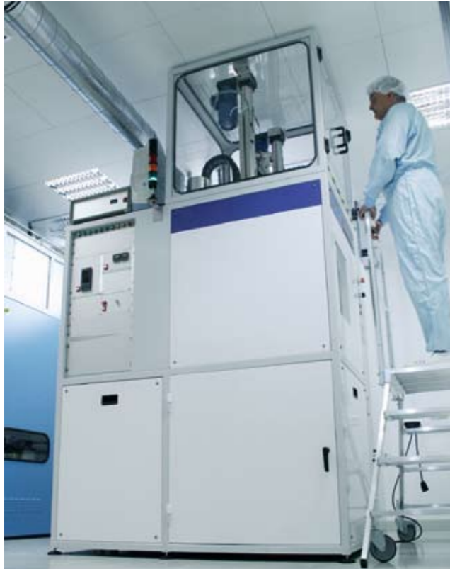
Abb. 1: Vertikale HVPE-Anlage (Prototyp) zum Wachstum von GaN-Kristallen Fig. 1 Vertical HVPE system (prototype) for GaN boule growth
