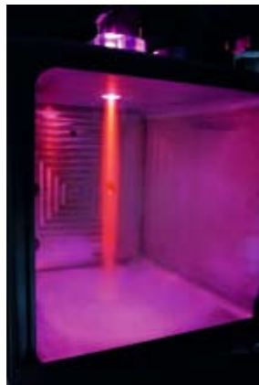
Abb. 3: Plasmaquelle für Unterdruckanwendungen Fig. 3: Plasma source for low pressure applications
