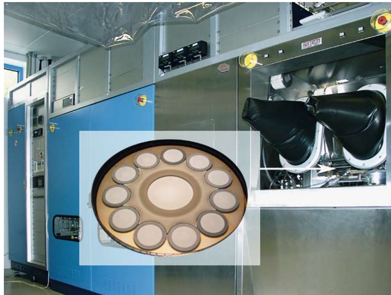
Abb. 1: MOVPE-Anlage für das Wachstum von (Al,Ga)N. Das Detailbild zeigt den Hochtemperatur-Suszeptor in der 11 x 2 Zoll Konfiguration. Fig. 1: MOVPE reactor for the growth of (Al,Ga)N. The inset shows the high-temperature susceptor with a 11 x 2 inch configuration.
