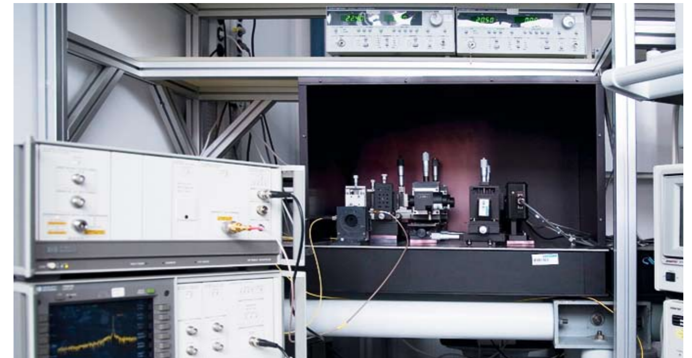
Abb. 5: Messplatz zur Bestimmung der Linienbreite Fig. 5: Experimental set-up for examination of line width
