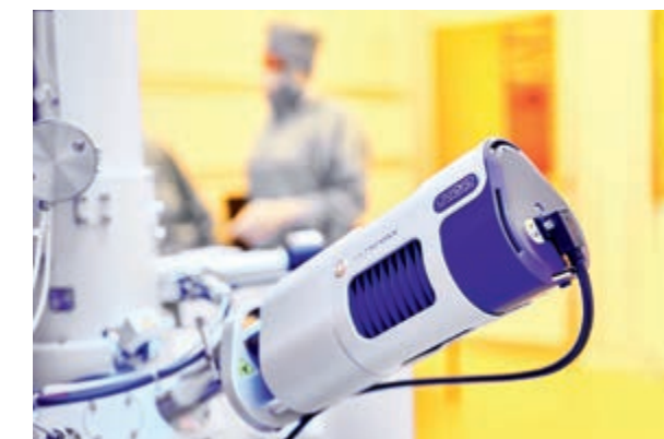
Waferstepper & Rasterelektronenmikroskop (REM) beim Einlegen einer Maske (o.) und Detektor am REM zur chemischen Elementbestimmung (u.)
