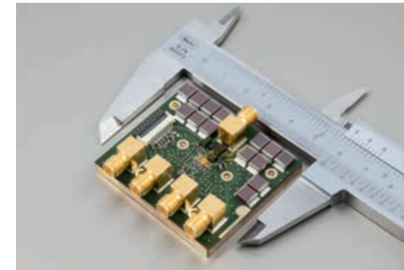
Digitales Leistungsverstärker-Modul für die mobile Kommunikation der Zukunft
