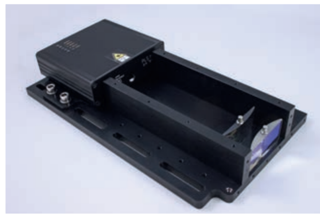
Für OQmented hat das Ferdinand-Braun-Institut eine Puls laserquelle inklusive Steuerelektronik entwickelt. Der MEMS-Spezialist hat dieses Modul mit weiteren Komponenten in sein LiDAR-System integriert. Im Test wurden Objekte in einem weiten Winkelbereich von 140 Grad in Entfernungen bis 25 Meter erkannt.
