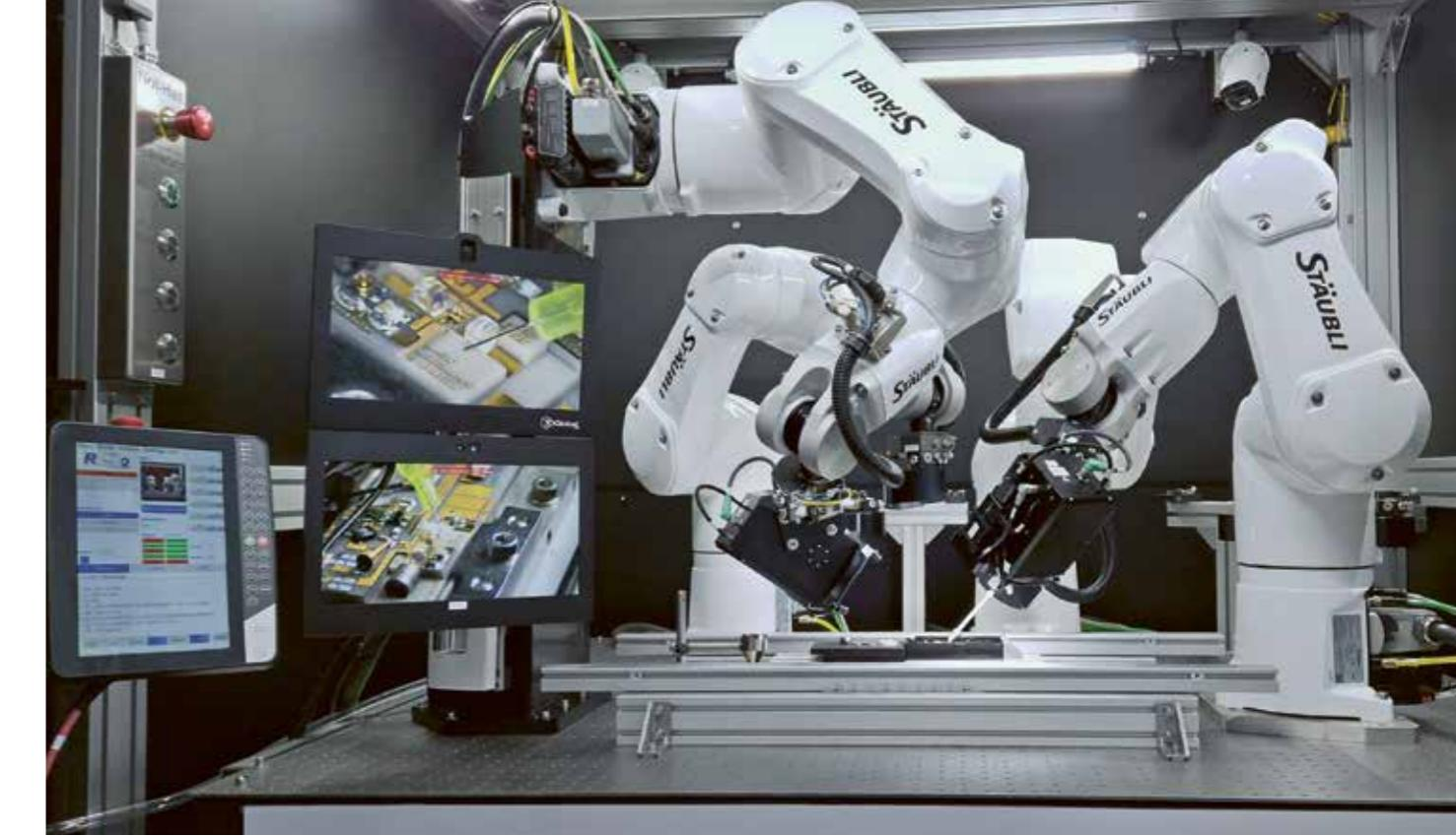
The intuitive robotic system 'Microbot' allows ultra-precision assembly of complex photonic modules containing lasers and lenses. Mit der intuitiv bedienbaren robotischen Anlage „Microbot“ lassen sich komplexe photonische Module mit Lasern und Linsen mit höchster Genauigkeit montieren.
