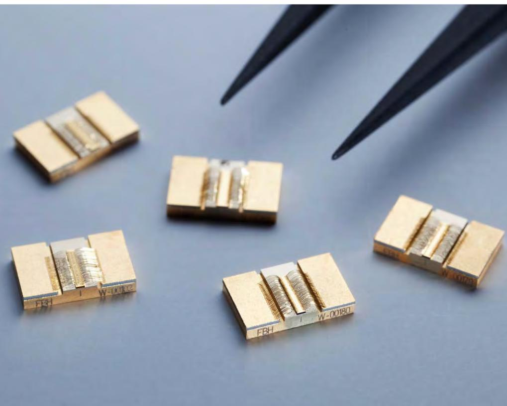
◀ 100 µm-Breitstreifenlaser mit 65% Effizienz bei 10 Watt Ausgangsleistung
