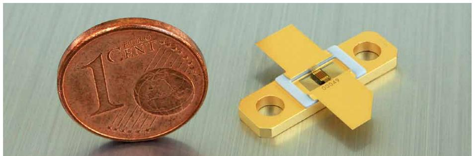
▲ Montierte GaN-Schottkydioden für den Betrieb bei 600 V, 1 A
