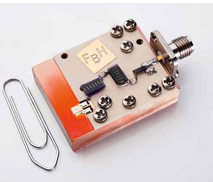
Fig. 1. Voltage-mode class-S amplifier.
