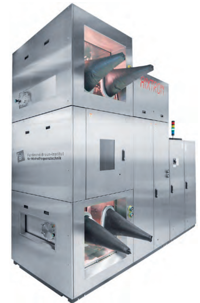
Abb. 2: Neue vertikale HVPE-Anlage. Fig. 2: New vertical HVPE system.
