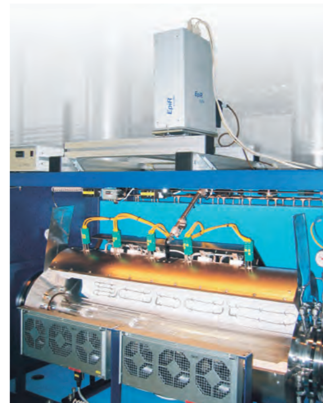
Abb. 1: Horizontale HVPE-Anlage zum Wachstum von Nitriden. Fig. 1: Horizontal HVPE reactor for nitride growth.
