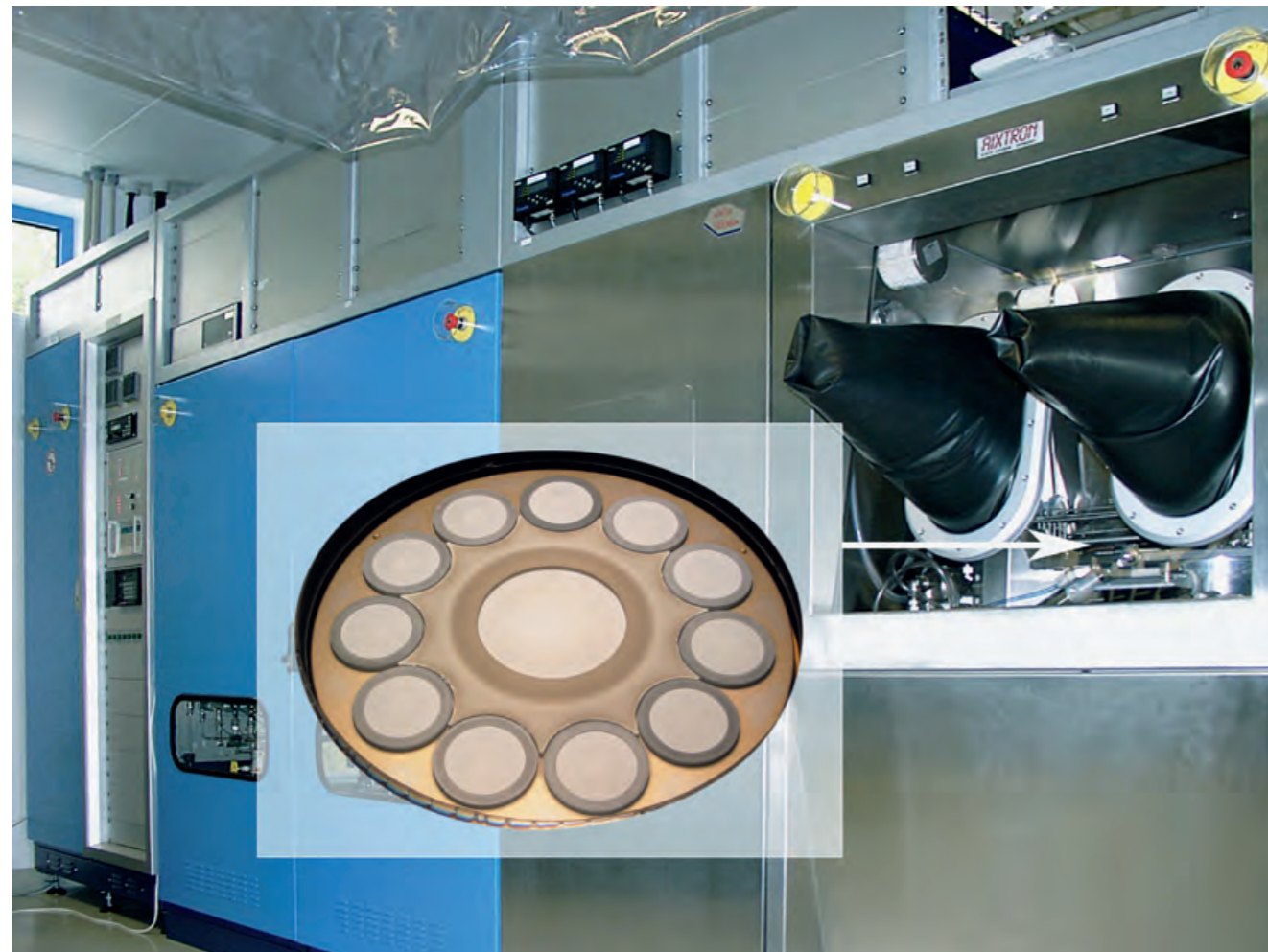
MOVPE-Anlage für das Wachstum von (Al,Ga)N, die im Projekt genutzt wird. MOVPE reactor for the growth of (Al,Ga)N which is used in the project.
