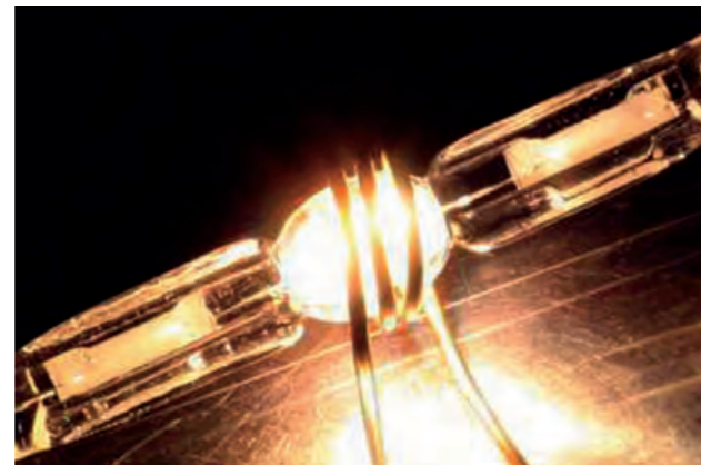
Abb. 2: Hochdruck-Plasma-Lichtquelle. Fig. 2: High-pressure plasma light source.
