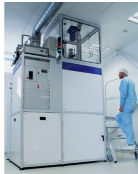
Abb. 1: Vertikale HVPE-Anlage (Prototyp der Aixtron AG) zum Wachstum von GaN-Kristallen. Fig. 1: Vertical HVPE system (prototype by Aixtron) for GaN boule growth.
