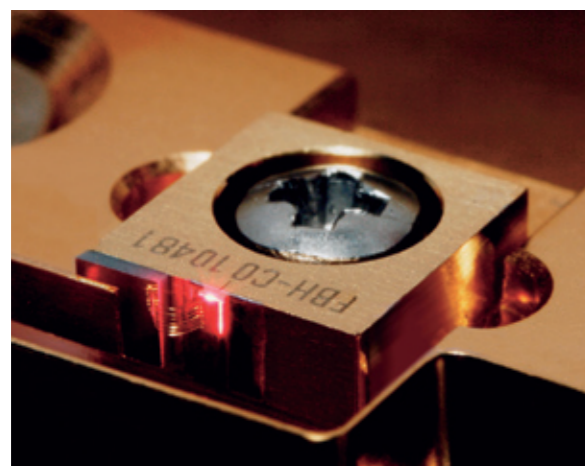
Abb. 1: 650 nm - Breitstreifenlaser auf C-Mount. Fig. 1: 650 nm - broad area laser on c-mount.
