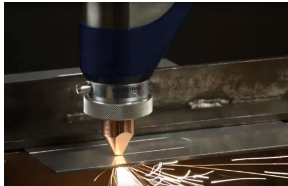
👉 Laser system using FBH diode lasers cutting sheet metal, developed within EU project BRIDLE . Lasersystem mit FBH-Diodenlasern, das im EU-Projekt BRIDLE entwickelt wurde, beim Schneiden von Metall.
