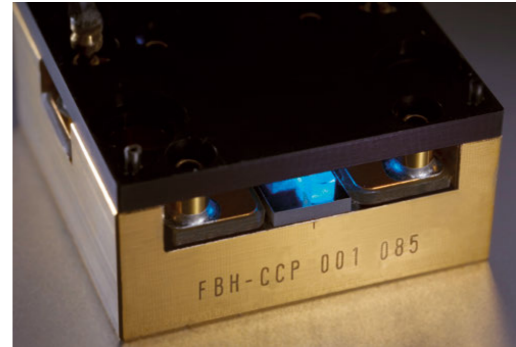
➤ Blue-emitting diode laser suited for Shifted Excitation Resonance Raman Difference spectroscopy. Blau-emittierender Diodenlaser, der sich für die Shifted Excitation Resonance Raman Difference Spektroskopie eignet.
