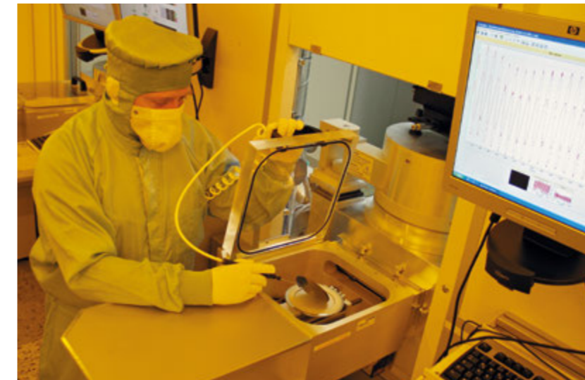
Plasma etching process in FBH's cleanroom. Plasma-Ätzprozess im FBH-Reinraum.
