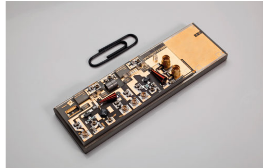
Hybrid-integriertes Master-Oscillator-Power-Amplifier-Lasermodul aus dem FBH für die Rubidium-Präzisionsspektroskopie im Weltraum.
